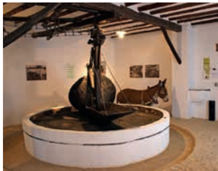
Viejo sistema de prensado por tracción animal. Museo de la Cultura del Olivo. La Laguna (Baeza, Jaén)
